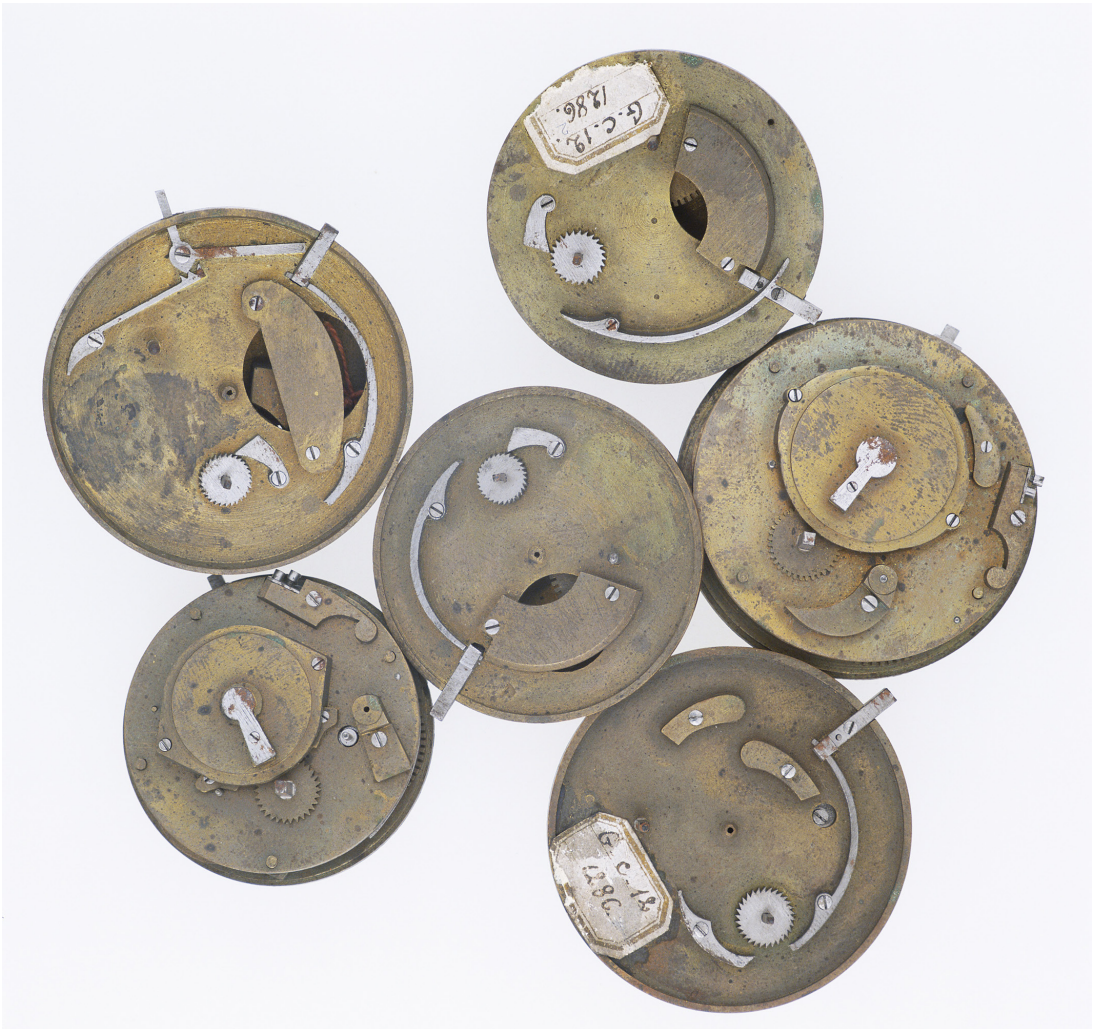
Fig. 3. Unfinished watch movements ( ébauches ) by the Japy firm, around 1800, Musée des Arts et Métiers, Paris, Inventory nos 01286-0001, 01286-0002, 01286-0003, 01286-0004, 01286-0005 and 01286-0006, © Musée des arts et métiers-Cnam, Paris, photo by P. Faligot.
